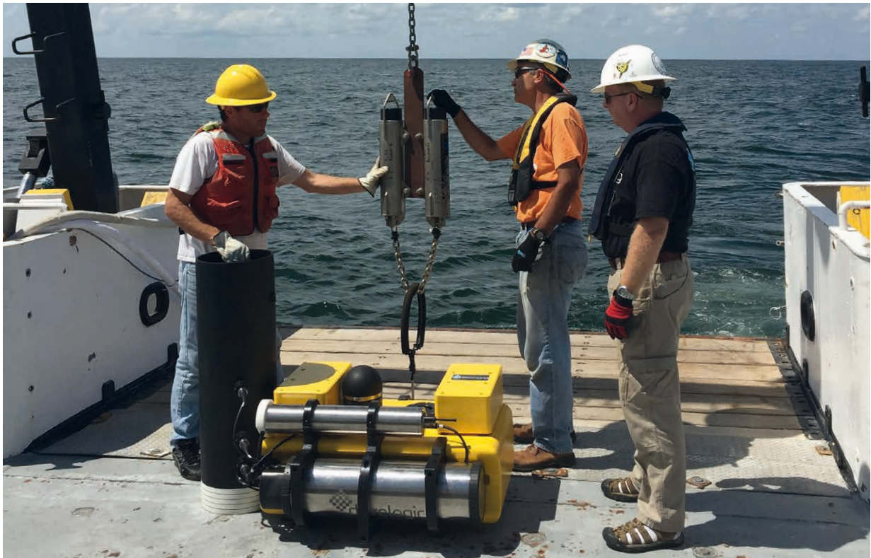
Die titanummantelten Sensoren werden auf offener See platziert. Sie ermöglichen eine reibungslose Übertragung der gesammelten Daten.
